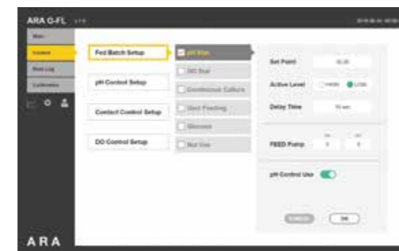
Fed Batch 설정에 따른 정량 펌프 제어
